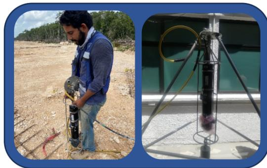
El equipo sonar MS1000 detecta la presencia y ubicación del objetivo en un medio acuoso mediante un transductor que genera un pulso de onda de sonido que es reflejada y refractada, datos necesarios para la visualización de imágenes en el software.
